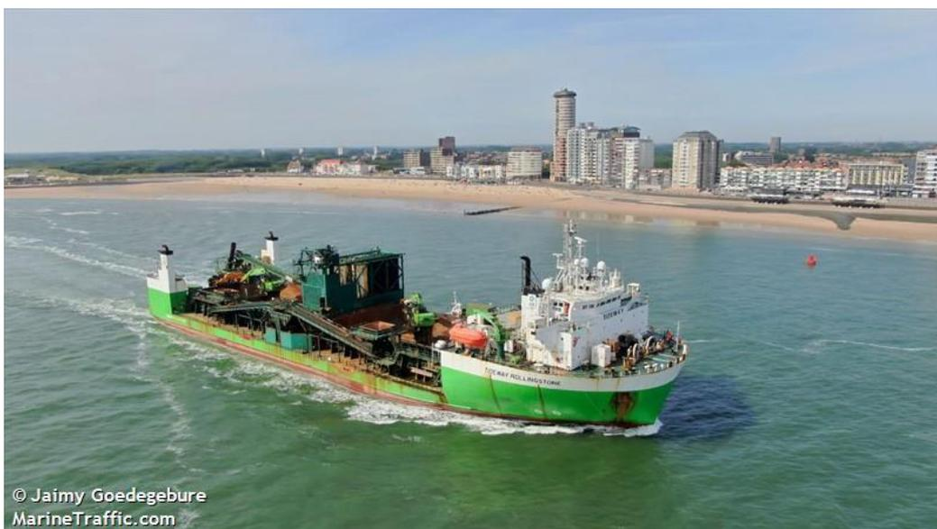
Figure 5: Navire de pose d'enrochement "Rolligstone de l'armateur DEME
