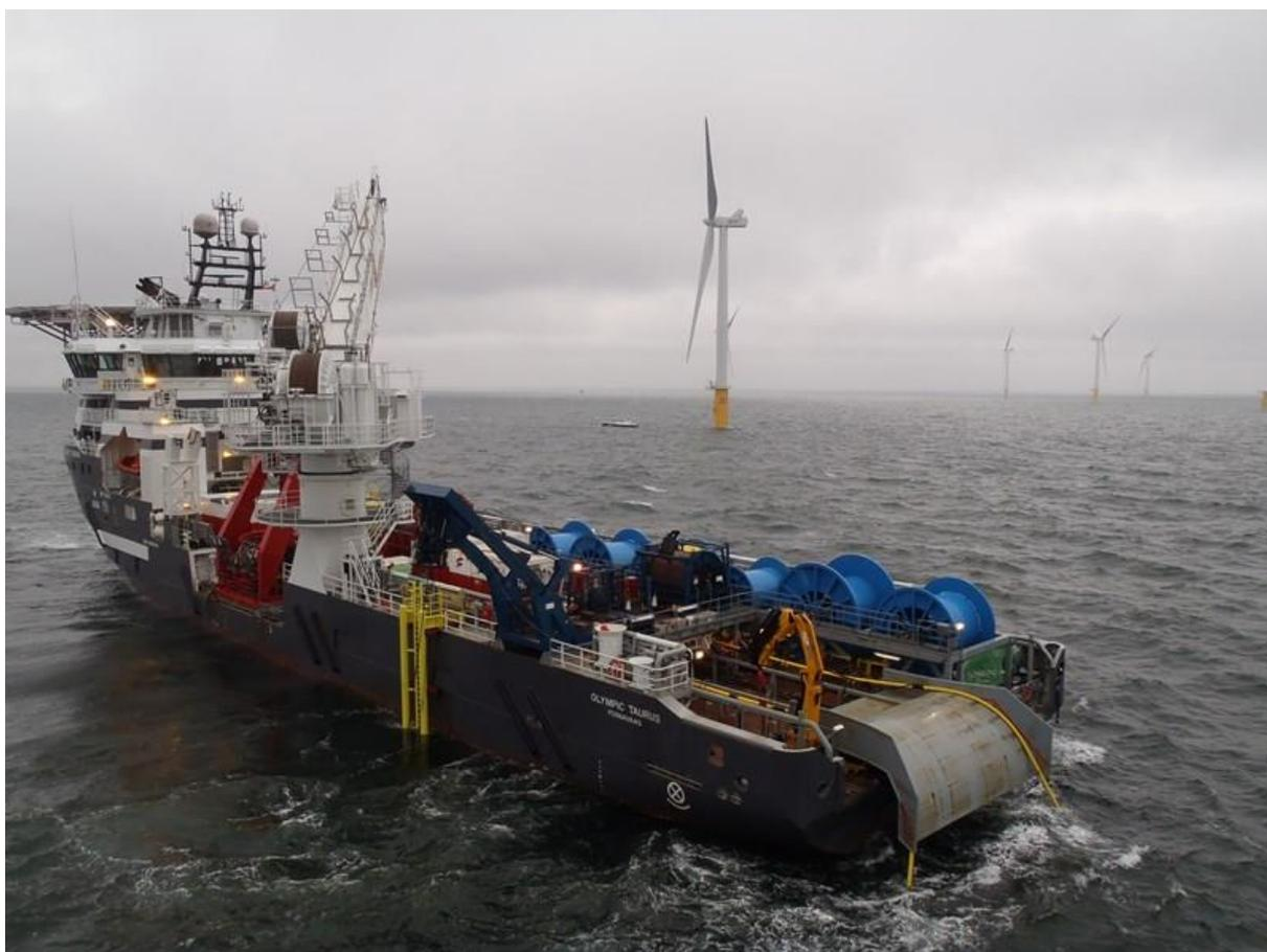
Figure 6 : Exemple de navire câblage
