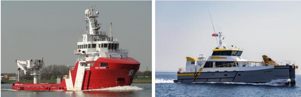
Figure 4 : Navire de support aux opérations d'installation des fondations, soit un navire de ravitaillement offshore (à gauche) ou un navire de transfert de personnel (à droite)
